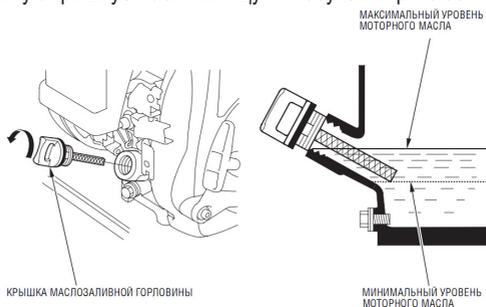
2. Вставьте и выньте щуп без завинчивания его в заливную горловину. Проверьте уровень масла, показанный на щупе.
