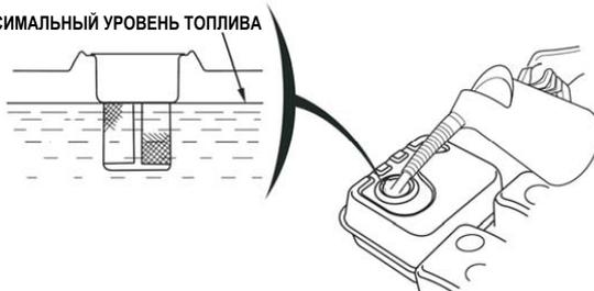
Перед запуском двигателя заливайте топливо в хорошо вентилируемом месте. Если двигатель работал, дайте ему охладиться. Дозаправку выполняйте аккуратно, не допуская разливов топлива. Не заполняйте выше плечика сетчатого фильтра. После дозаправки надежно затяните крышку топливного бака.
