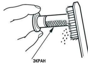
4. Используйте щетку, чтобы удалить углеродистые отложения с сетки искроуловителя. Будьте аккуратны, чтобы не повредить сетку. На искроуловителе не должно быть никаких трещин или дыр. Замените искроуловитель в случае его повреждения.
